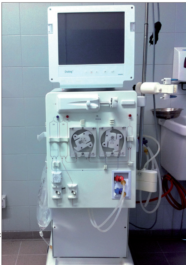
Rycina 1. Typowe urządzenie do dializy nerkowej przystosowane do zabiegów metodą przerywaną (IHD)
