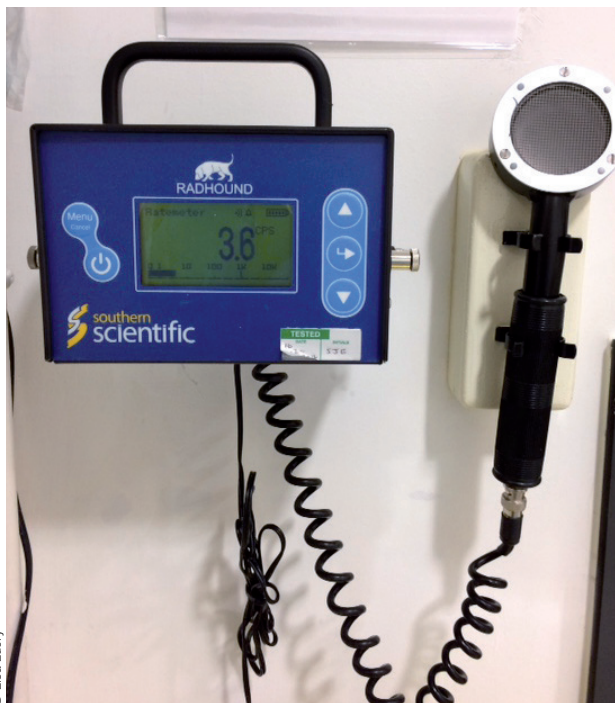
Figura 3. Puede utilizarse un contador Geiger para garantizar que la radioactividad sea suficientemente baja como para poder dar de alta al gato y monitorizar al personal hospitalario.
