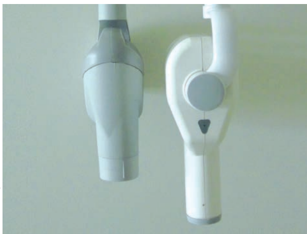
Figura 2. Aparatos de radiología dental con diferentes longitudes de PID; la unidad dental con un PID más largo producirá una imagen de mayor calidad, pero necesitará más potencia para generar fotones de rayos X.
